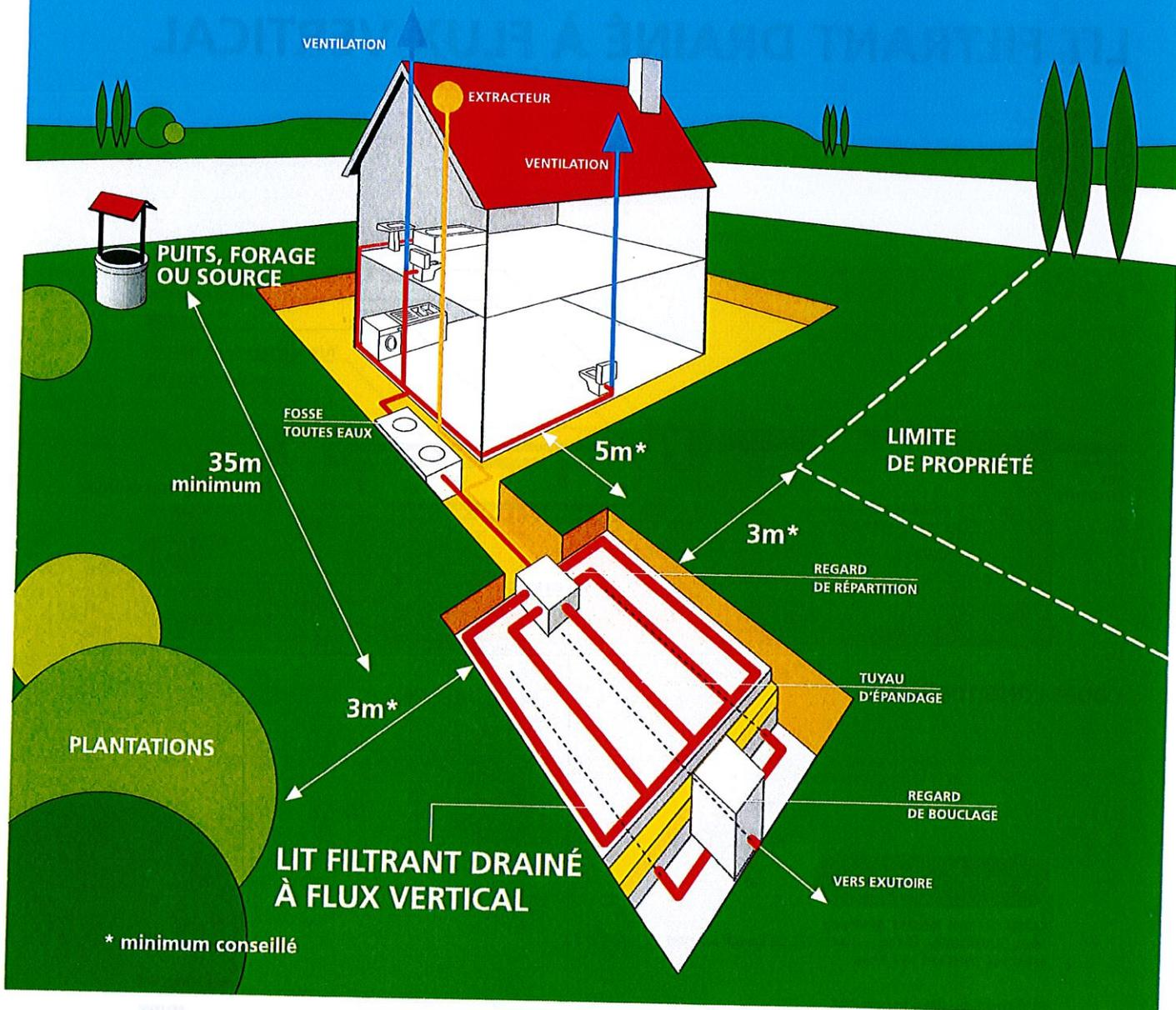
Ce dispositif est à prévoir lorsque le sol est inapte à un épandage naturel et lorsqu'il existe un exutoire pouvant recevoir l'effluent traité.
